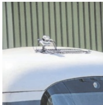
Der LiDAR-Sensor auf einer Straßenbahn. Foto: Linz AG; Lidar Punktwolke: JKU/Linz AG
