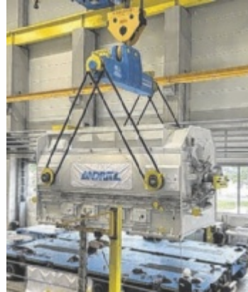
Verladung eines 250 Tonnen-Turbogenerators bei Andritz in Linz. Foto: Andritz Data
