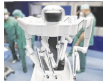
Ein Da-Vinci-OP-Roboter für minimal-invasive Eingriffe
