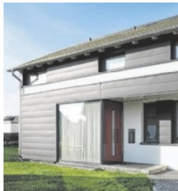
Ein Haus mit einer hinterlüfteten Aluminium-Fassade Foto: epr/PREFA/Croce&Wir
