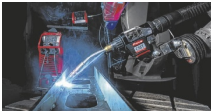
CMT kommt überwiegend beim Roboterschweißen zum Einsatz.
