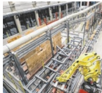
Die Fertigungsstraße für Ziegelfertigwände (l.) und das Fenster-Komplettsystem „Windowment“ (r.) am neuen ETZI-Standort Fotos (3): Thomas Brunner photography
