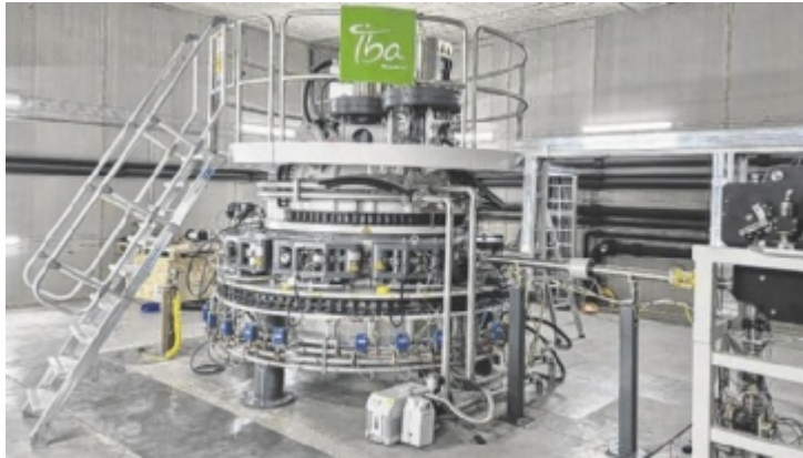
Der Elektronenbeschleuniger „Rhodotron“ in Kremsmünster Foto: Greiner Bio-One
