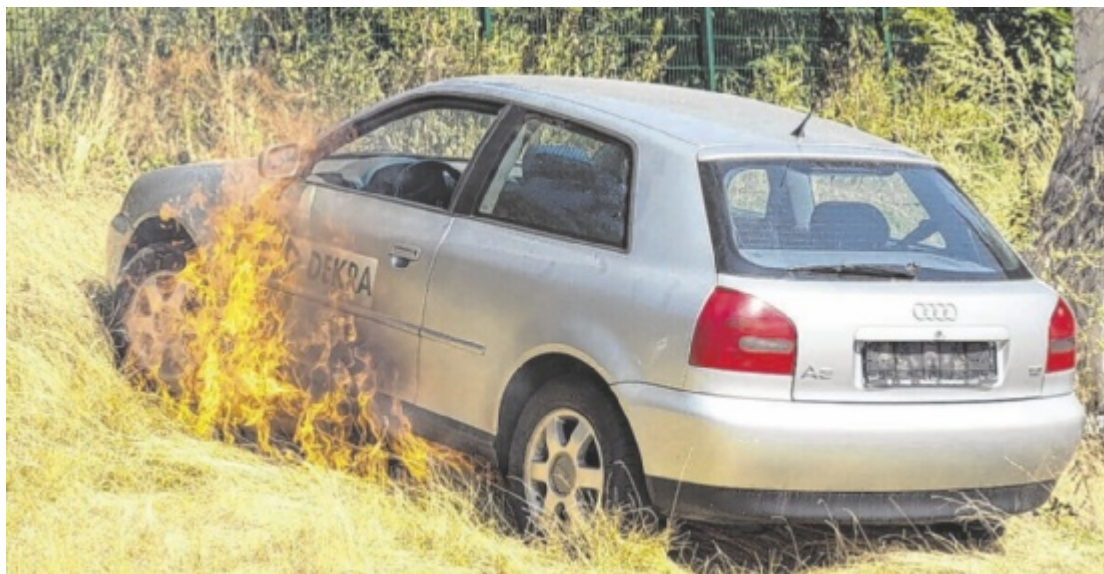
Ein heißer Katalysator setzt bei einem Versuch von DEKRA die trockene Böschung in Brand.
