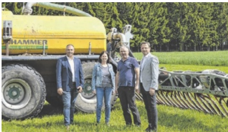
Mit einem Schleppschlauchsystem wird Gülle bodennah ausgebracht. Das bietet dem Bauern Vorteile und stinkt außerdem weniger. V. l.: Martin Moser (Obmann Bezirksbauernkammer Freistadt), Sieglinde und Alfred Siegl und Johannes Gahleitner (Leiter Bezirksbauernkammer Freistadt)
