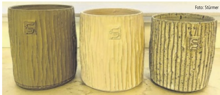
Der Ton schrumpft vom Rohmaterial bis zum fertigen Becher circa zehn Prozent, v. l.: geschälte Grünware (ungebrannt), geschälte Schrühware (erster Brand bei 950 Grad Celsius) und fertiger Kaffeebecher (zweiter Brand bei 1.230 Grad Celsius)
