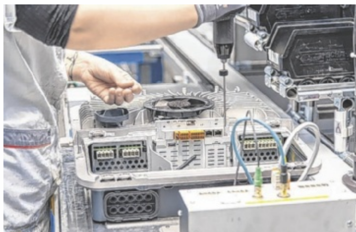
Fertigung eines Wechselrichters bei Fronius
