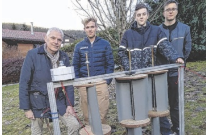
Harald Weihtrager (I.) und Schüler der TFS Haslach mit dem Prototypen der Windwand. Diese kann laut Weihtrager zum Beispiel auch als Absturzsicherung auf einem Flachdach dienen; und gleichzeitig Strom erzeugen. Foto: Weihtrager
