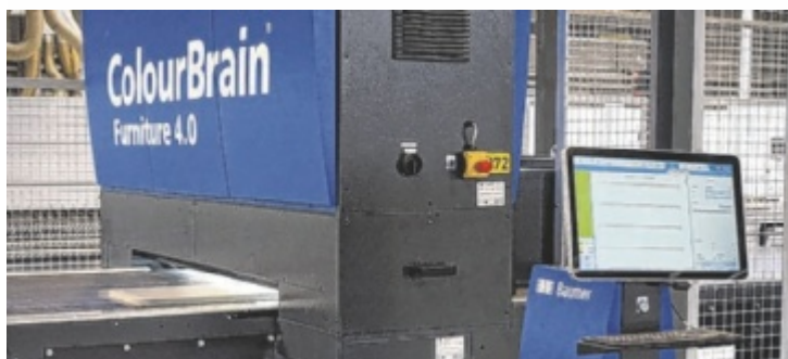
Die neue Anlage „Colourbrain Furniture“ im Unternehmen hali überprüft Plattenzuschnitte und kann Mängel wie Kratzer erkennen.
